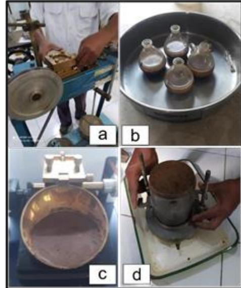
Gambar 5. Pengujian tanah (a) kuat geser (b) berat jenis (c) batas plastis (d) kelulusan air (Sabo, 2024)
