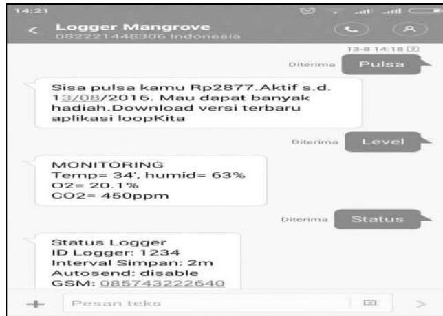
Gambar 7. Tampilan format SMS dan balasan dari modem GSM
