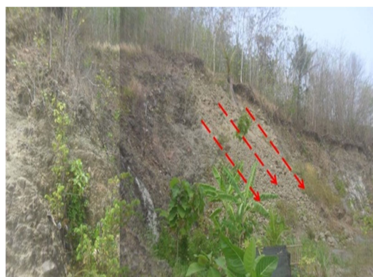
Gambar 2. Longsoran massa batuan vulkanik berupa blok-blok lava andesit dan breksi andesit di tebing pada posisi koordinat 7°59'20,88" LS 110°19'19,09" BT.
