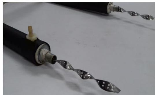
Gambar 3. Penukar kalor pipa ganda dengan penambahan *perforated twisted tape*
