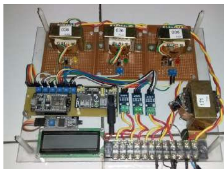
Gambar 4. Realisasi alat monitoring tegangan dan arus motor induksi tiga phase dengan IoT
