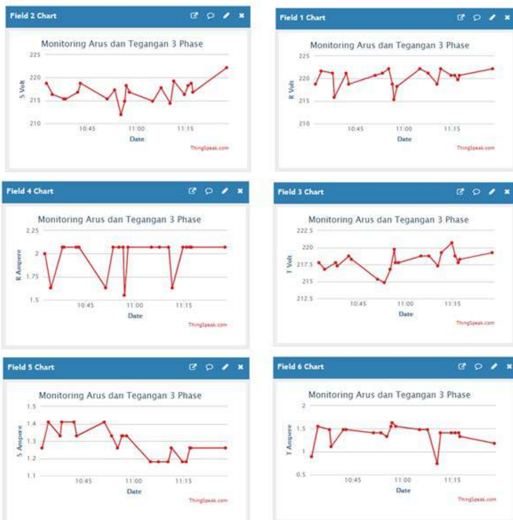
Gambar 11. Hasil desain penampil tegangan dan arus tiga phase pada Thingspeak
