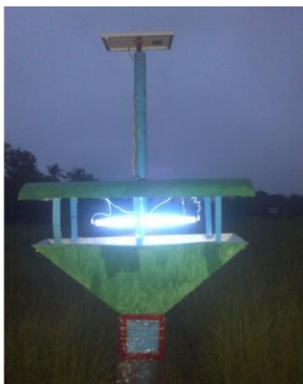
Gambar 3.1 Prototipe Alat Penangkap Serangga Menggunakan Tenaga Surya (Solar Cell)
