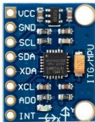
Gambar 2. Bentuk fisik Modul IMU GY521 yang berbasis MPU6050
