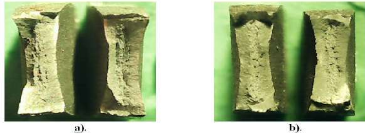
Gambar 4. Foto makro hasil pengujian tarik pengelasan fcaw, a). tanpa penambahan panas; b). dengan penambahan panas 200 °C.
