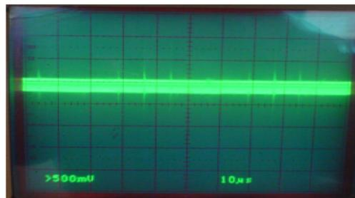
Gambar 7. Bentuk Gelombang Keluaran Rangkaian Detektor Puncak ke Puncak
