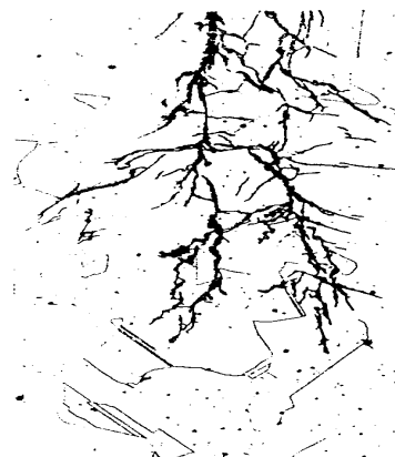
gambar 1. Retakan korosi tegangan pada stainless steel (Fontana, 1987)
