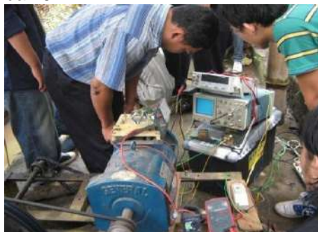
Gambar 6. Kondisi Generator AC di lokasi PLTMh Dalam tahap pengukuran.
