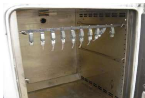
Gambar 3 Proses penuaan dengan oven
