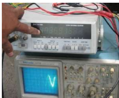
Gambar7. Pelaksanaan pengukuran tegangan, frekuensi dan arus.
