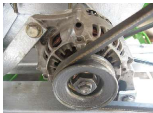
Gambar.9 Generator Mini Yang dapat menyesuaikan putaran pada PLTMh.
