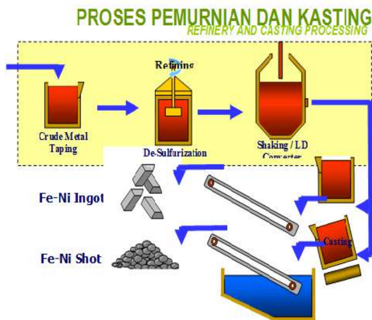
Gambar 1. Skema Proses Operasi Pemurnian dan Kasting
