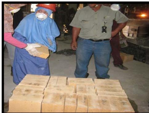
Gambar 6. Foto Batu tahan api jenis magnesia (MgO *brick*) yang digunakan *lining* pada Tanur listrik
