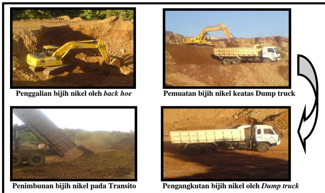
Gambar 2. Foto rangkaian kegiatan penambangan pada PT ANTAM Tbk. UBPN Sul-Tra
