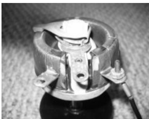
Gambar 4. Bentuk Fisik Potensiometer Jenis Wire Wound
