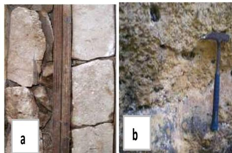
Gambar 4a. Litofacies *grainstone* (klastik) dengan *oil trace* (kiri: warna putih kecoklatan), *no oil trace* (kanan). Gambar 4b. Atas: Singkapan batugamping non klastik, facies *bafflestone* (branching corals) dan *bindstone* (*platy corals*). Bawah: klastik: facies *algae grainstone* berlapis buruk. Contoh singkapan Formasi Wonosari
