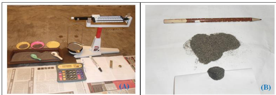
Gambar 2. Salah satu set alat dan bahan yang digunakan dalam penelitian laboratorium/studio (gambar A) dan pasir hasil pemisahan antara mineral magnetik, ditunjukkan pada pasir bagian bawah, masih dalam pengaruh magnet; dan mineral non-magnetik, ditunjukkan pasir pada bagian atas, tidak terpengaruh oleh magnet (Gambar B).
