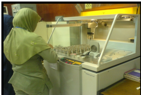
Gambar 5. Foto tahap analisa kadar unsur dengan Sinar X pada Axios Panalytical .
