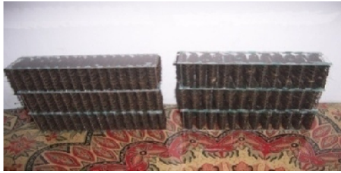
Gambar 2. Dua tipe Bahan Isian, kerapatan 28,3 \cdot 10^{-4} \text{ kg/m}^3 (3 buah ditumpuk, bagian kiri) dan 21,7 \cdot 10^{-4} \text{ kg/m}^3 (3 buah ditumpuk, bagian kanan)
