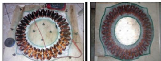
Gambar 5. Kumparan siap diberi campuran resin (kiri), kumparan yang sudah diberi campuran resin dan di-press (kanan).
