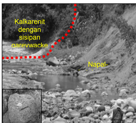
Gambar 3. Kenampakan dua kelompok batuan yang menyusun daerah Tinatah. Bagian Utara Kalkarenit, bagian selatan napal-batulempung. Insert : breksi fragmen batulempung
