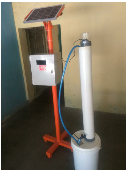
Gambar 4. Alat hasil Rekayasa untuk pendeteksi dini bencana banjir berbasis IoT menggunakan Raspberry Pi
