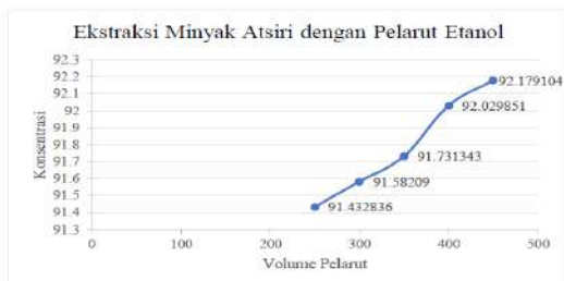
Gambar 8. Grafik konsentrasi minyak atsiri terhadap volume pelarut etanol
