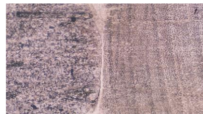
Gambar 3.5 : Struktur Mikro Batas Baja Karbon dan Baja Tahan Karat dengan Pengelasan Cara Butter, Arus 100A
