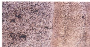
Gambar 3.1 : Struktur Mikro Batas Baja Karbon dan Baja Tahan Karat dengan pengelasan Cara Butter, Arus 80A.
