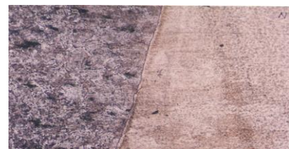
Gambar 3.6 : Struktur Mikro Batas Baja Karbon dan Baja Tahan Karat dengan Pengelasan Cara Langsung, Arus 100A
