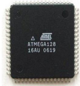
Gambar 3. IC Mikrokontroler ATMEGA 128
