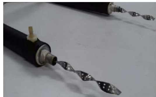
Gambar 3. Penukar kalor pipa ganda dengan penambahan perforated twisted tape
