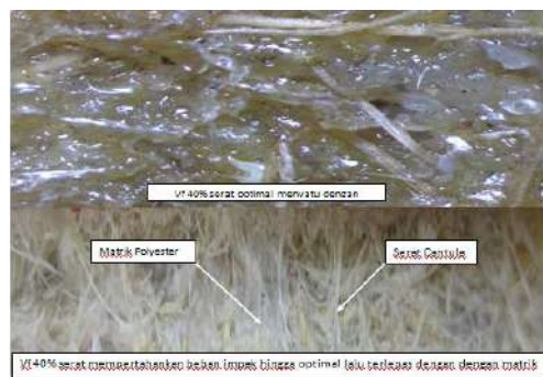
Gambar 3. Foto makro penampang patahan komposit akibat uji impak
