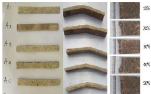
Gambar 2. Penampang patahan komposit akibat uji impak
