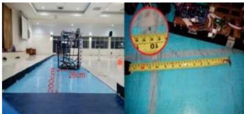
Gambar 5 a). Pengujian Pergerakan Robot Open Loop dari Titik A ke Titik B b). Error Pergerakan Robot Open Loop dari Titik A ke Titik B
