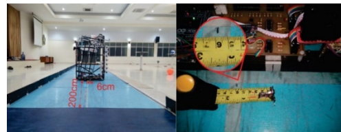
Gambar 12a). Pengujian Pergerakan Robot kontrol PID dari Titik A ke Titik B b) Error Pergerakan Robot kontrol PID dari Titik A ke Titik B
