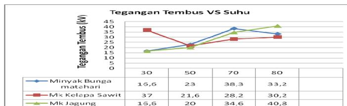
**Gambar 3.** Grafik Pengujian Tegangan Tembus (kV)
