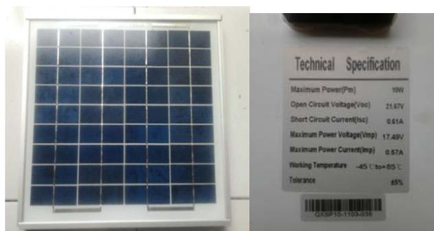
Gambar 2 Panel Surya dengan daya10Wp dan Spesifikasi teknis panel surya
