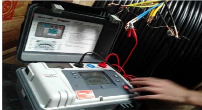
**Gambar 6.** Pengukuran Tahanan Isolasi Menggunakan Megger.
