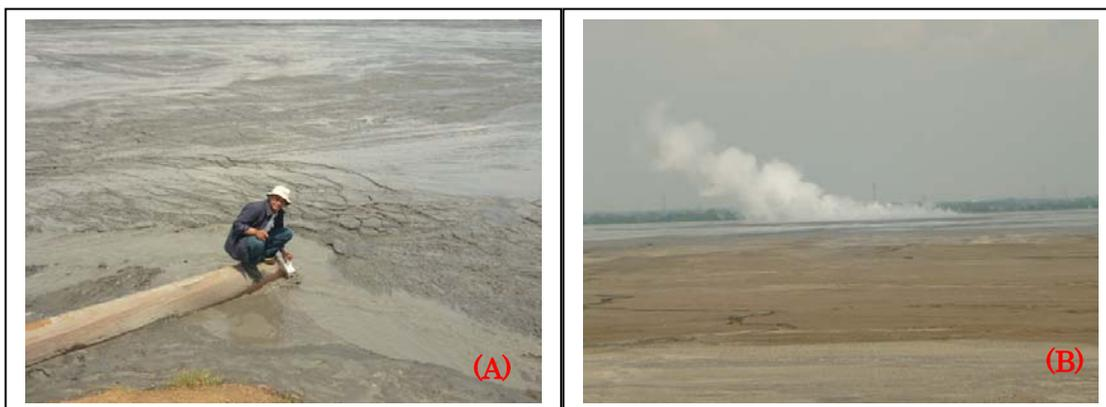
**Gambar 2.** Pengambilan sampel lumpur (*disturb sample*) dekat lokasi amblesan pada posisi koordinat  $7^{\circ}31'53,35''$  LS  $112^{\circ}42'30,37''$  BT (gambar A) dan semburan lumpur dan gas pada posisi kurang lebih 1 kilometer utara lokasi pengambilan sampel (gambar B)
