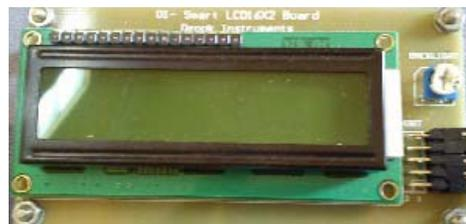
**Gambar 7.** Tampilan LCD 2x16 sebagai blok output
