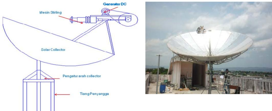
Gambar 2 Desain konsentrator parabola dan mesin stirling
