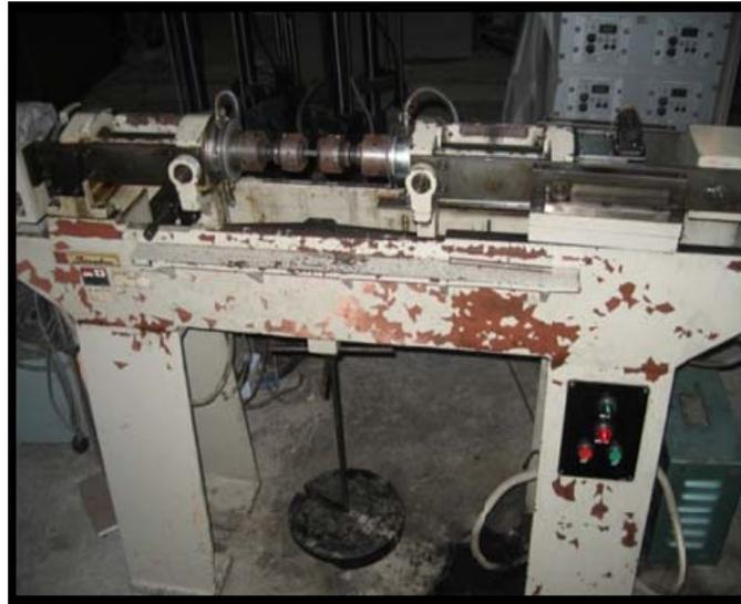
**Gambar 2.** Alat uji rotari bending
