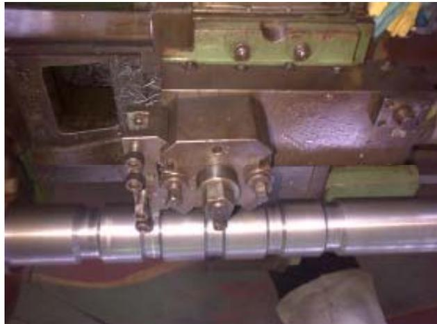
Gambar 2.4. Proses Permesinan (pembubutan) Silinder Komponen Mesin Roll
