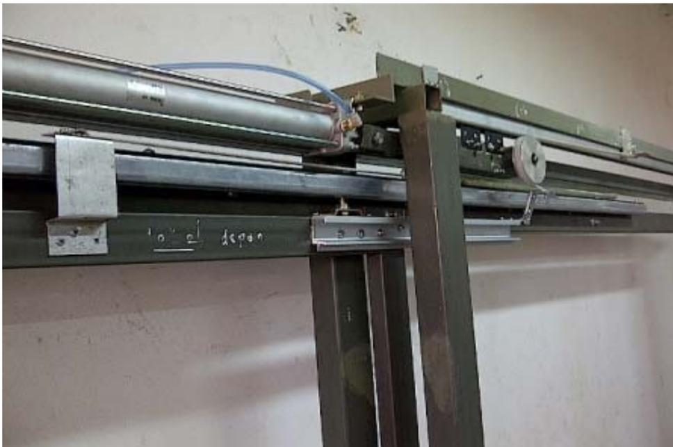
**Gambar 5.** Silinder pneumatik dan susunan puli – sabuk terpasang di atas pintu.
