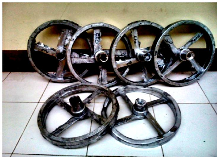
Gambar 3. Produk centrifugal casting
