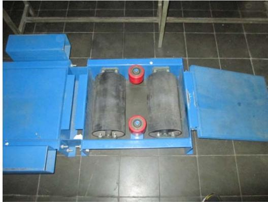
Gambar 3. Dinamometer
