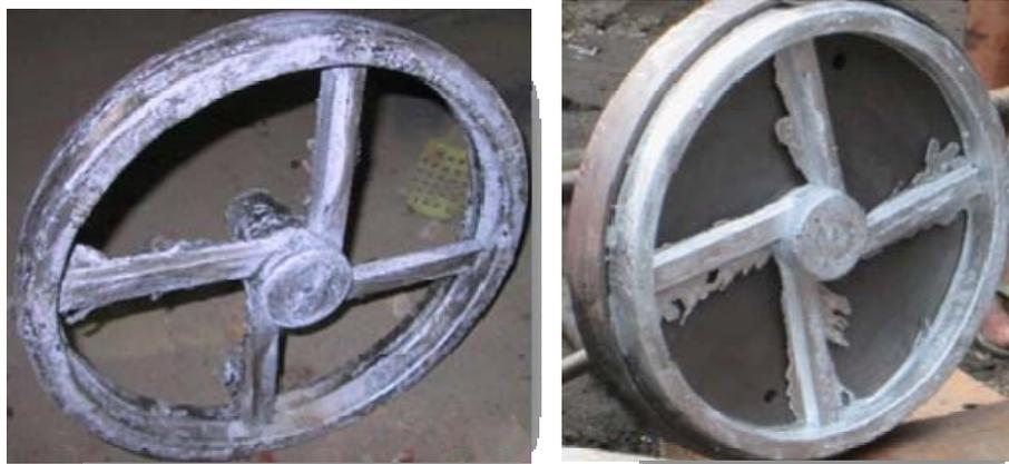
**Gambar 3.** Velg hasil pengecoran dengan centrifugal casting
