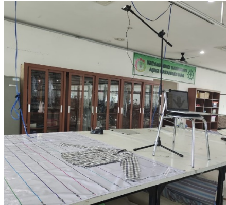
Gambar 2.3 Sistem Pengukuran Pakaian Berbasis Pengolahan Citra Digital
