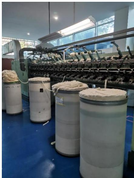
Gambar 6. Proses Pembuatan Benang OE
