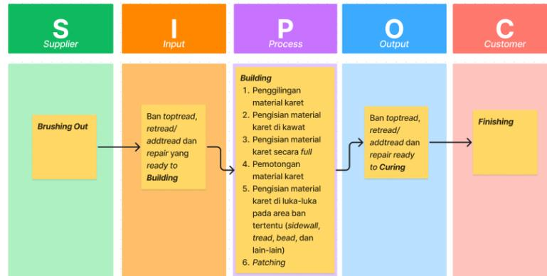
Gambar 1. Diagram SIPOC Proses Produksi Ban
