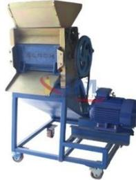
Gambar 1. Mesin pengupas kulit salak.
