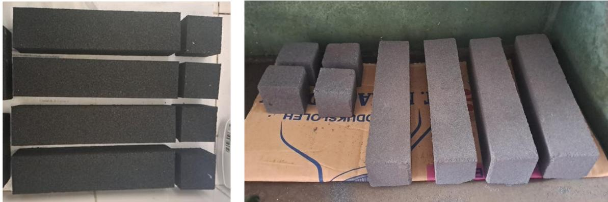
**Gambar 4.** Spesimen CCS dan MoR (Sebelum dan Setelah Sintering)
