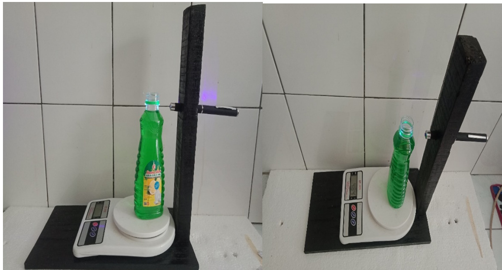
Gambar 5. Gambar alat sederhana untuk meminimalisir kemasan tidak penuh
