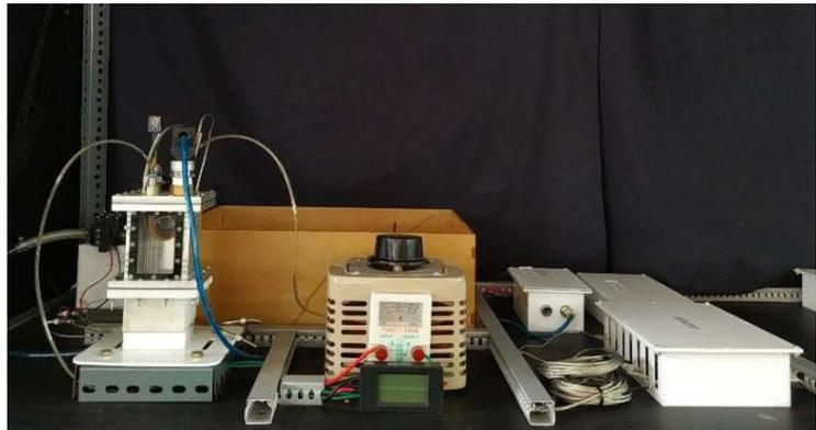
Gambar 3. Skema dan Foto Fasilitas Uji Pool Boiling
