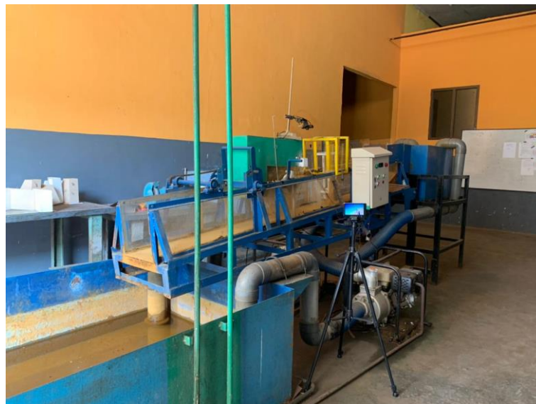
Gambar 2. Instalasi pengujian kincir air dengan sluice gate
