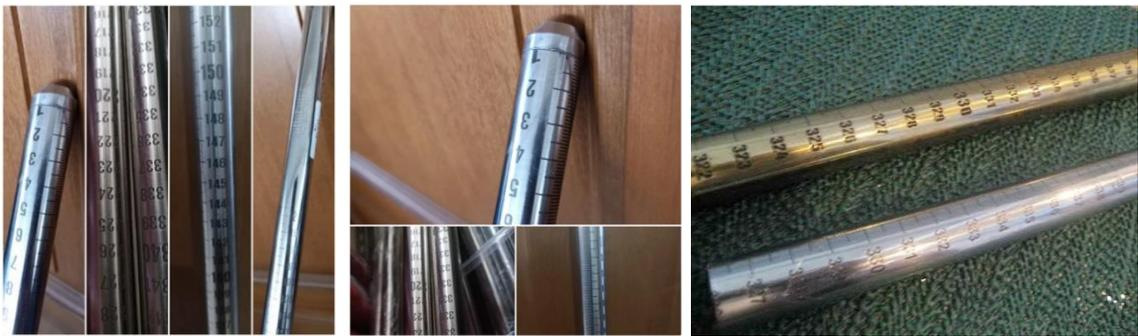
Gambar 2. Dipstick atau Stick Sounding Bahan Bakar Minyak
