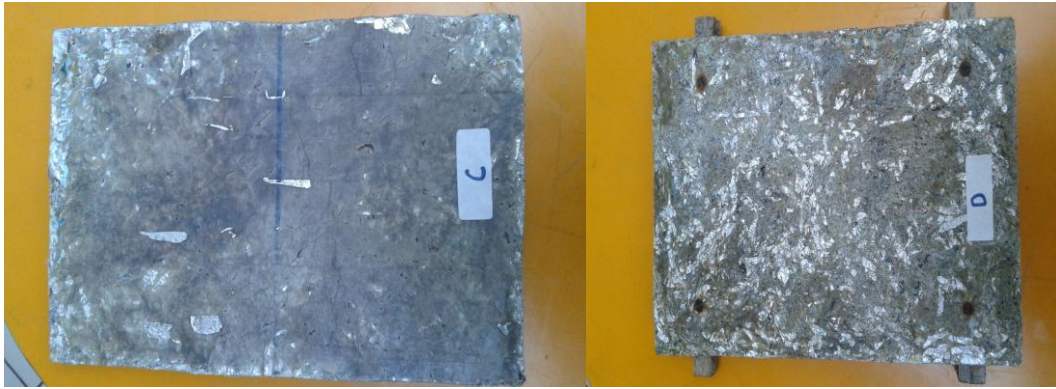
Gambar 7. Hasil Permukaan pakoplas setelah di ekspos pada berbagai kondisi
