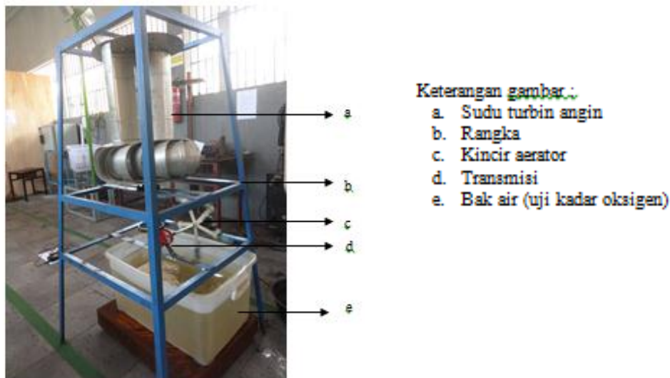
Gambar 1. Alat uji aerator tambak tenaga angin poros vertikal
