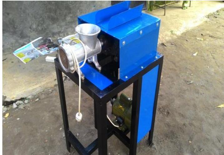
Gambar 2. Mesin perajang limbah buah model screw
