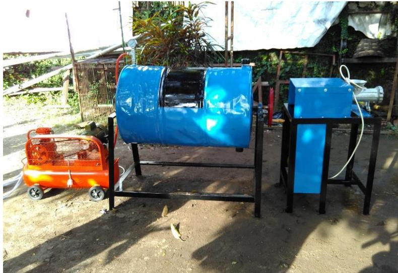
Gambar 4. Sistem integrasi (penghancur limbah buah-digester biogas-kompresor pengisi)
