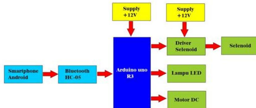
Gambar 4. Blok Diagram Rangkaian Sistem
