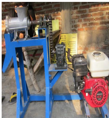
Gambar 6. Hasil Perakitan Mesin Penghancur sekaligus Pembuat Pelet nila-lele
