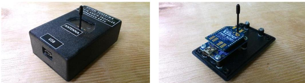
**Gambar 9.** Perangkat Keras Sistem Penerima, (a). Bagian Luar, (b). Bagian Dalam
