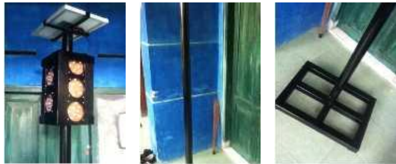
Gambar 10. (a). Bagian Box Lampu Pejalan Kaki dan APILL (LED); (b) Bagian Tiang Penyangga, c. Bagian Penyangga Bawah (Tempat untuk Box Sistem Pengatur)
