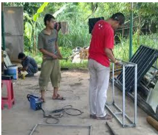
**Gambar 3. Pengelasan rangka vertikal**
