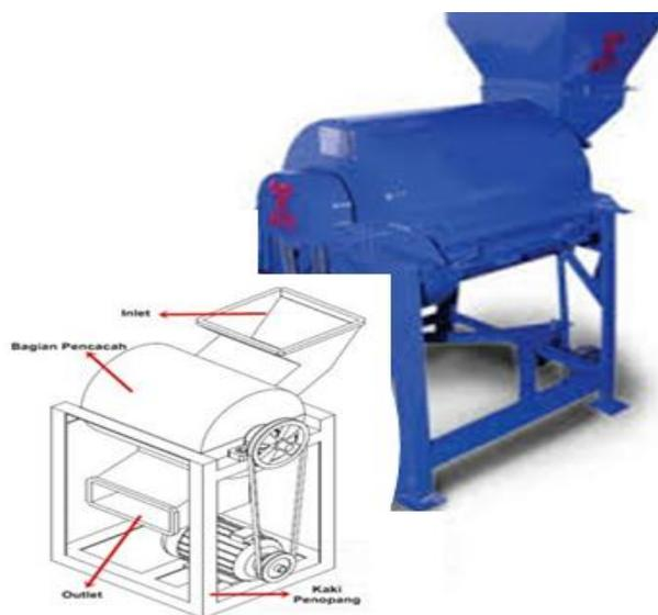
**Gambar 6. Hasil Perakitan Mesin Penggiling**
