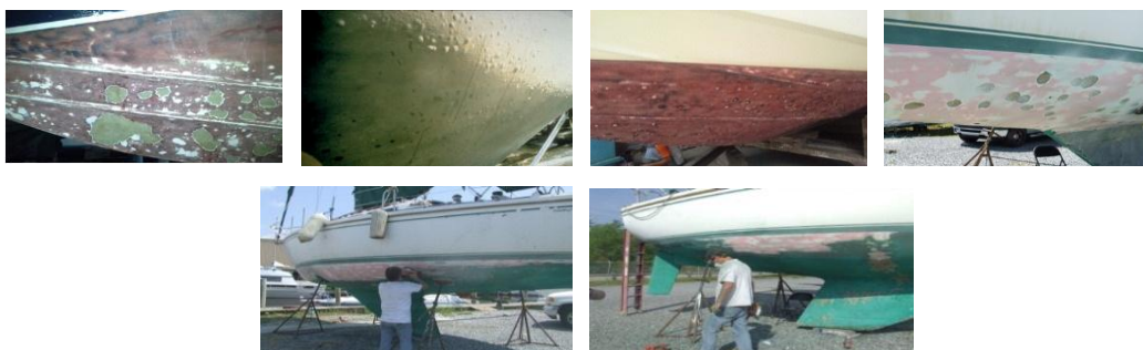
Gambar 7 Kondisi blistering dan perawatan zona lambung kapal fiber glass
