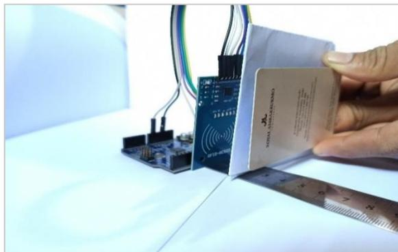
Gambar 9. Pengujian Kartu Rfid Menggunakan Penghalang Kertas
