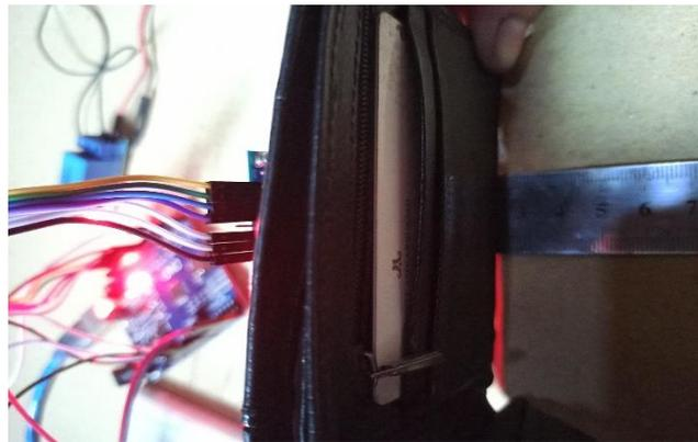
Gambar 11 Pengujian Kartu Rfid Menggunakan Penghalang Dompot
