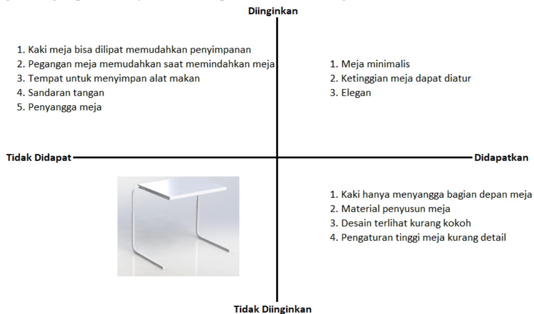
Gambar 1. Identifikasi produk Meja Makan Lansia dan Rawat Inap dengan menggunakan customer windows
