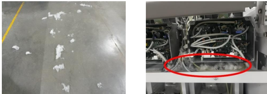
(a) Lingkungan Kurang Bersih (b) Kebersihan Mesin Kurang Gambar 6. Penyebab Benang Cacat Faktor Lingkungan
