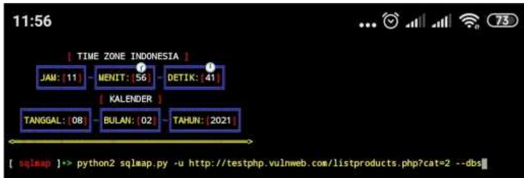
Gambar 5. Perintah untuk Pengujian Keamanan Basis Data Situs Web dengan SQLMap Tool di Termux
