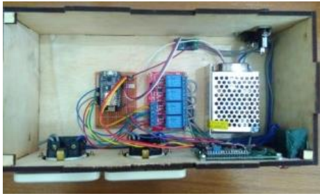
(b) Bagian Dalam Gambar 5. Hasil Implementasi Desain Hardware Aplikasi Sistem Pemantauan dan Pengendalian Beban Listrik Berbasis Internet of Things (IoT)
